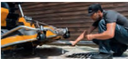
Alle Combi-Mähdecks lassen sich in eine Reinigungsposition bringen. Die Verwendung von Hochdruckreinigern sollte jedoch vermieden werden.
