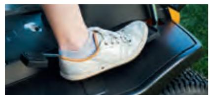
Komfort auch bei dem kleinen Aufsitzmäher. Beim Hydrostatgetriebe regelt man den Fahrtrieb über eine Pedalwippe.
